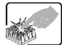
系统运作时，微处理器和散热片可能会发烫。某些板卡和底座零件也可能会有尖锐的插销和边缘。请在需要触摸这些地方时格外小心，并戴上防护手套。
